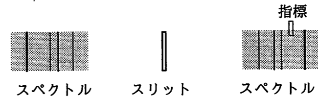
図1：簡易分光器をのぞいたとき観測されるスペクトルの様子
