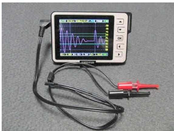
図1 DSONanoV2 の外観・標準プローブ
