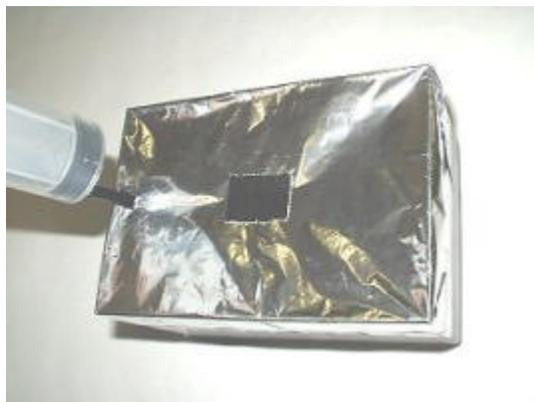
【写真7】外壁と仕切り板の間に薬液を注入する。注射針はストロー。
