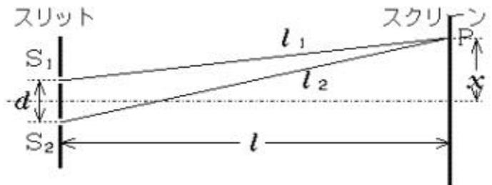
$l_1 = S_1P$ 、 $l_2 = S_2P$  を  $d$ 、 $l$ 、 $x$  で表し、 $l = l_2 - l_1$  を求める。
