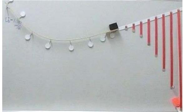
神奈川県の水上市慶文氏はあらゆる実験を黒板上で演示する。一般教室に道具を持ち込んで黒板を実験室にしてしまう。<sup>1)</sup>これにヒントを得て、できるだけ手軽に扱えて、しかも効果的な放物運動の演示をめざして工夫したものが上の実験装置である。<sup>2)</sup>
