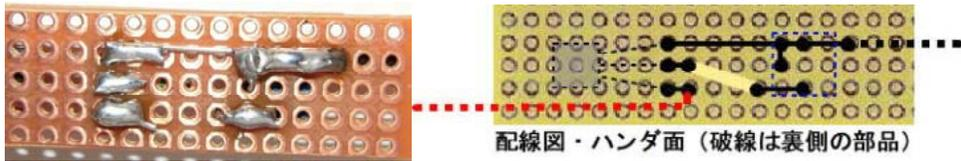
配線図・ハンダ面（破線は裏側の部品）
