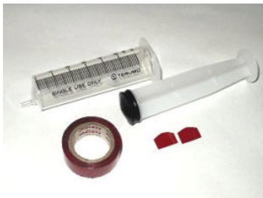
千枚通しで注射器のシリンダの先端に直径 2 mm 程度の穴をあけます。位置は、中心と外壁のちょうど中間、ノズル位置とは反対側です。（写真参照）
