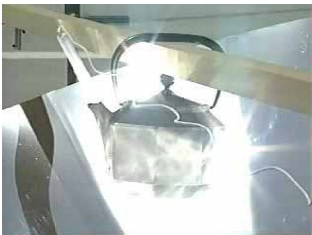
写真2 焦点に置いた鉄瓶
