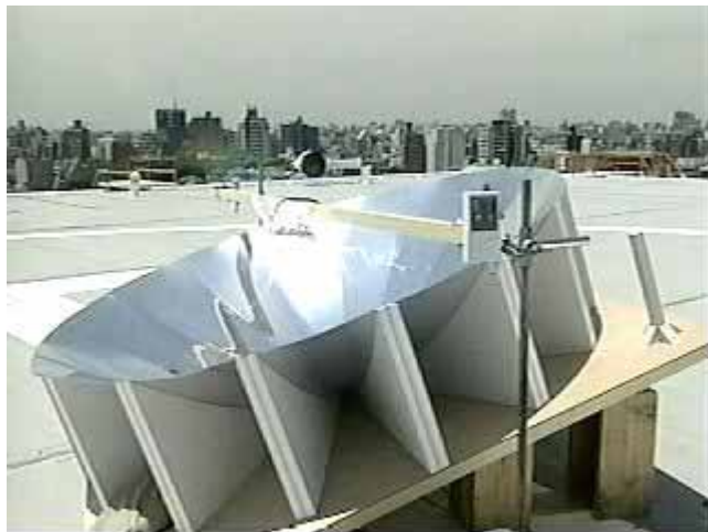
写真1 太陽熱湯沸器全景
