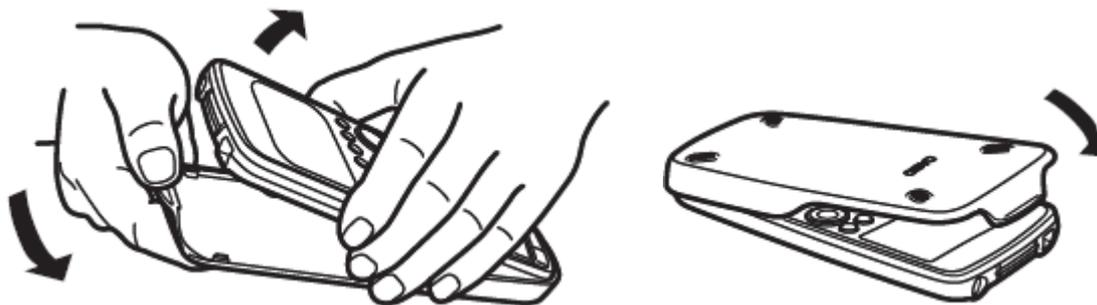
2)本体裏面の①の部分に指をかけて電池ブタをはずし、向きに気をつけて新しい電池
