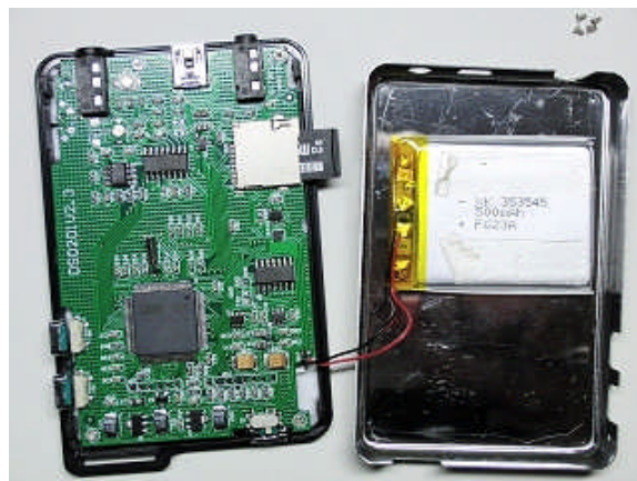
図 10 裏蓋を開けると電池と基板が見える
