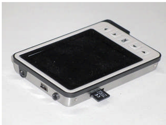
図 3 側面のジャック、USB 端子、カードスロット
