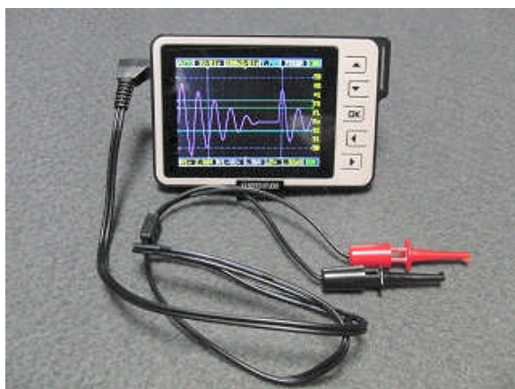
図 1 DSONanoV2 の外観・標準プローブ
