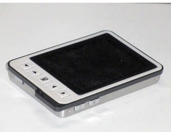
図 2 表面に 5 個・上側面に 2 個の操作ボタン
