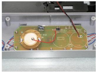
装置の心臓部にあたる基板は中央の黒い部分にLSIがモールドされているらしく、この部分で計測、計算、表示器制御のすべての処理が行われていると考えられます。基板上部に並んでいる金色の端子列は液晶表示器と接続する部分です。
