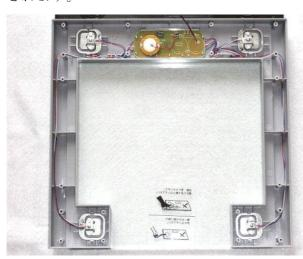
右の写真は力センサー部分の拡大です。中央のブリッジの部分の丸い「へそ」に押す力が加わると、その下の板ばねが変形して、そこに接着してあるストレインゲージが伸びることによる抵抗変化を電気的に検出しています。
