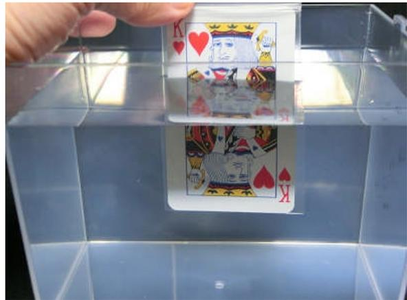
ばわかるように、この際、面 BC の右側の全ての領域からの光が BQ 間の「窓」を通過して視点 E に届く。視点 E からは点 Q より下も含めて「向こう側」の光景が全部 PB 間に圧縮されて見えるのである。
