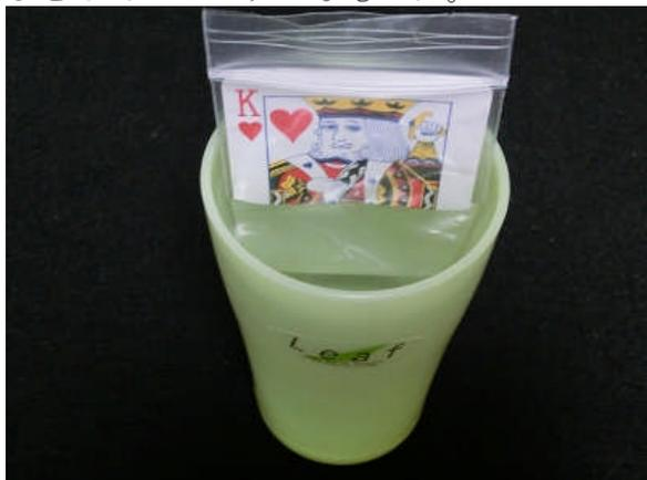
このとき袋の表面、厳密に言うと袋の内側の空気との境界面において全反射が起こっていると説明される。袋の表面にはコップの底の方面が映っており、袋の中からの光は遮断されているように見える。実際、コップの底にコインでも沈めれば、その反射像が鏡に映したように袋の表面に鏡像となって見える。
