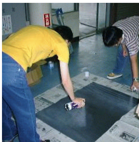
【図1】スプレー糊をむらなく吹きつける
