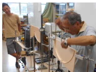
↑ サイクロイドの等時性。振幅によらないのでどこからスタートしても最下点で衝突する。
