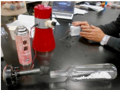
←杉本さんの実験用具一式。スピーカーは古いトランペットスピーカーをばらしたものです。アンプにハンドマイクを使ったり、スマホからWiFiで音声を飛ばしたり、いろいろな工夫が施されています。
