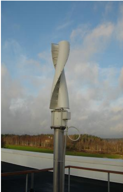
サボニウス型風車風力発電機
