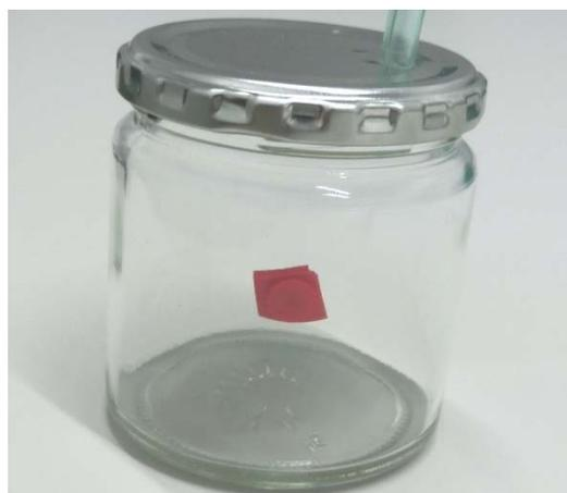
それでは、まわりの空気をなくしたら吸盤はくっつかなくなるのでしょうか。実験セットには赤い小さな吸盤がついていますのでよく観察してみましよう。ビンの空気をぬいていくと吸盤がふくらむようにしてはずれます。外の空気が吸盤をおしつけていたことがわかります。
