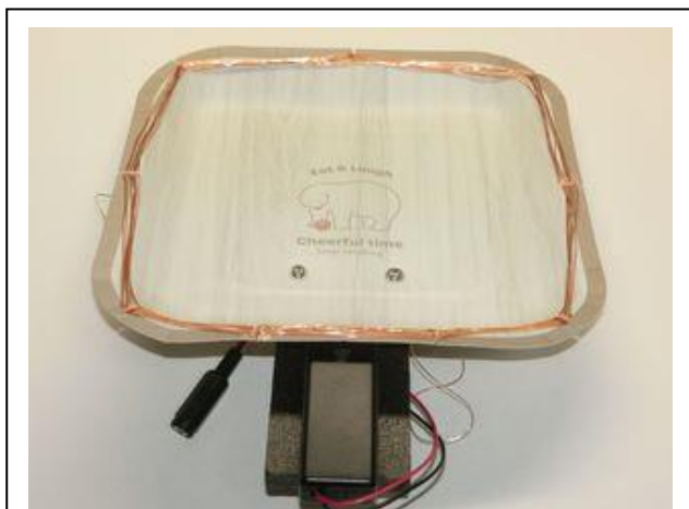
図1 AMラジオ表面 紙皿にエナメル線を巻いたコイルがアンテナになります。
