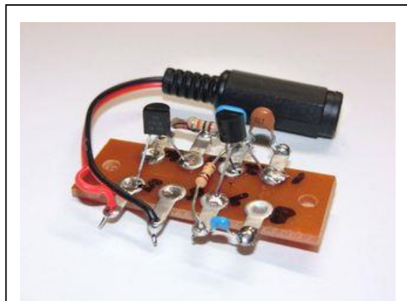
図 15 ラグ板の左右を逆にし、5～8番を手前側にしてトランジスタのとりつけ
