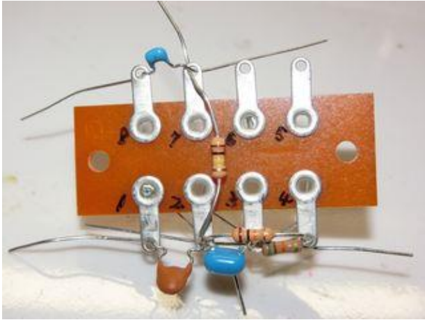
図 11 抵抗とコンデンサーをさしこむ
