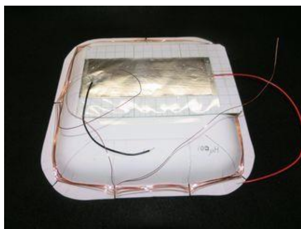
図30 可変コンデンサーを皿の裏にはる
