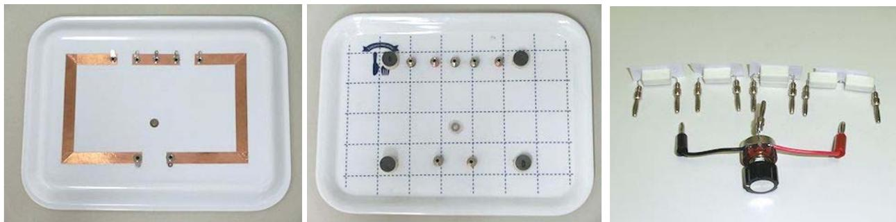
20~100  $\Omega$  程度の固定抵抗器やポリウムが取り付けられるようにバナナチップをハンダ付けした。(写真右)
