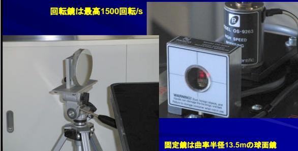
固定鏡は曲率半径13.5mの球面鏡
