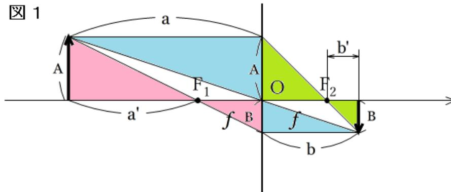
凸レンズを例にとる。図1で、原点Oにレンズがあり、物体Aの像がBにできているとする。A、Bがそれぞれの大きさを表している。F<sub>1</sub>、F<sub>2</sub>が焦点で、焦点距離はfである。a' = a - f、b' = b - fは式(2)の左辺に登場する量で、物点距離、像点距離からそれぞれ焦点距離を差し引いた長さである。
